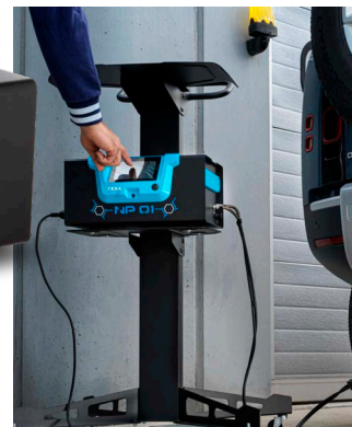
NP 01 je prvo orodje TEXA nove generacije instrumentov, razvito in zasnovano za merjenje koncentracije delcev v emisijah motornih vozil.
