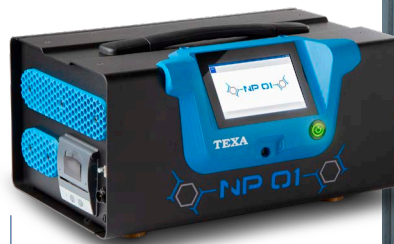
NP 01 je prvo orodje TEXA nove generacije instrumentov, razvito in zasnovano za merjenje koncentracije delcev v emisijah motornih vozil.
